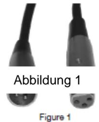
**Achtung:** Halten Sie sich für die Verlegung eigener Kabel an die Abbildungen 2 und 3. Benutzen Sie nicht die Masse am XLR-Stecker. Verbinden Sie den Massestift nicht mit der Abschirmung des Kabels und vermeiden Sie, dass die Abschirmung mit dem Gehäuse des XLR-Steckers in Kontakt kommt. Ein Kontakt der Abschirmung mit der Masse verursacht einen Kurzschluss und Störungen im Verhalten der Geräte.
